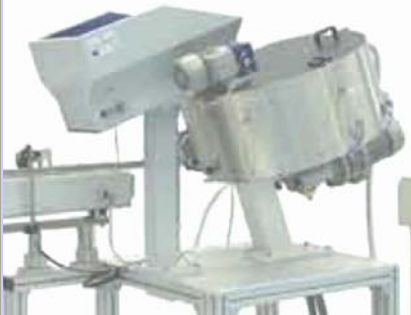
Elevator voor triggers en bunkerbak met band.
